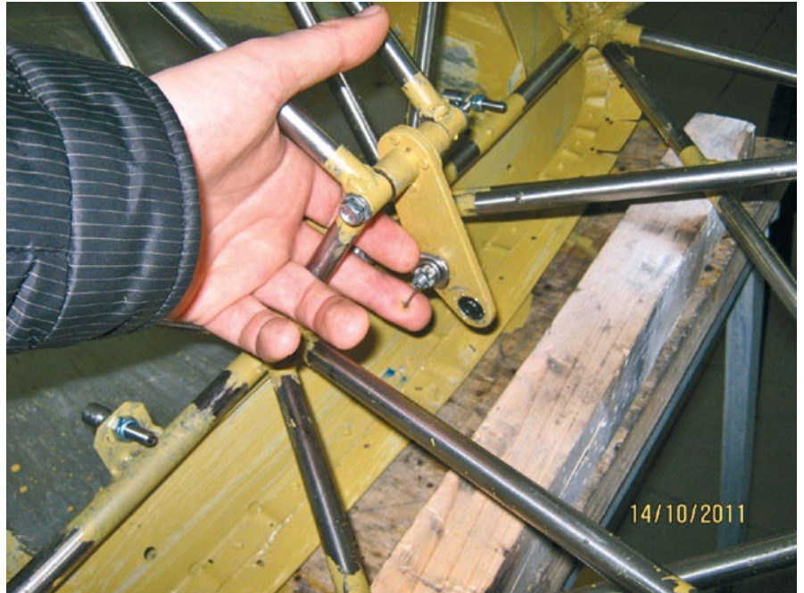
Установка качалки ГО
