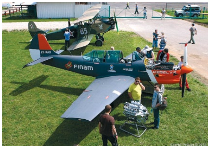
Экспериментальный Як-52 с двигателем А03
