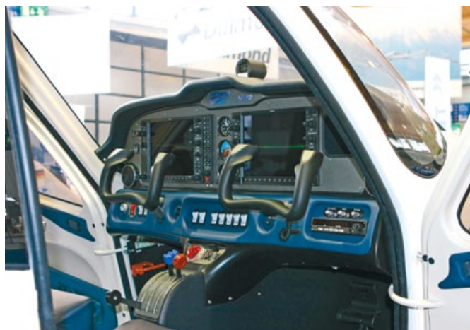
Кабина P2010 с комплексом Garmin 1000
