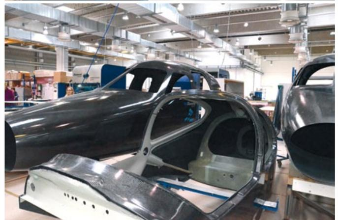
Цех по производству агрегатов из композиционных материалов
