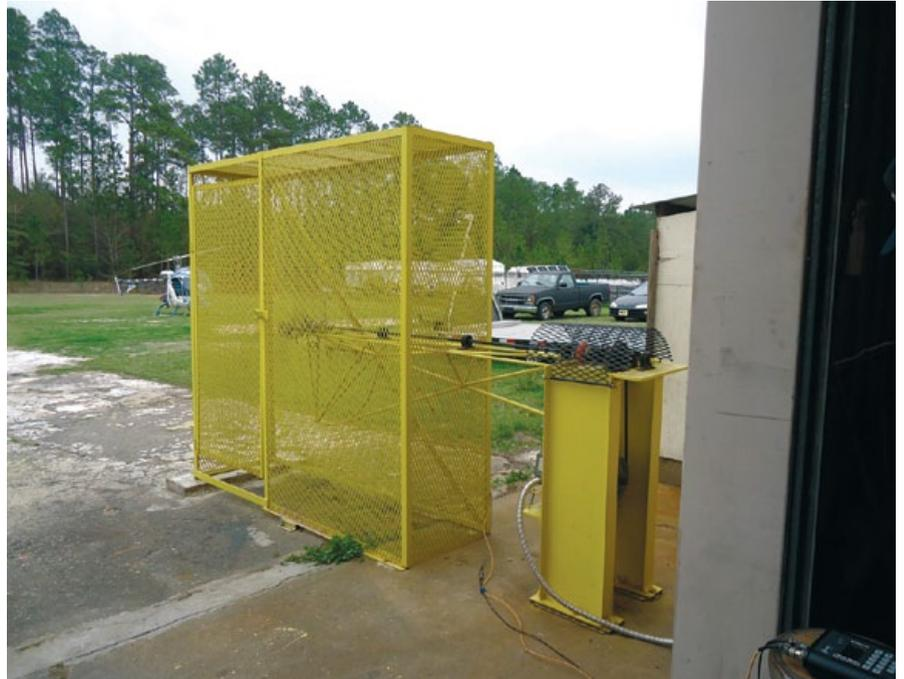
Стенд для испытаний хвостового редуктора
