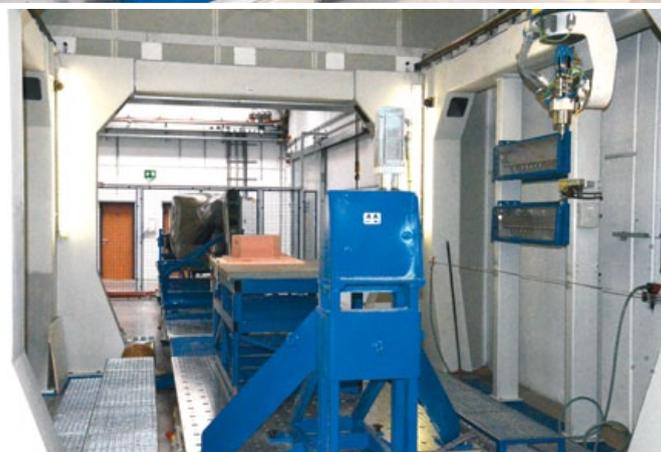
Комплекс изготовления матриц и контурной обрезки агрегатов
