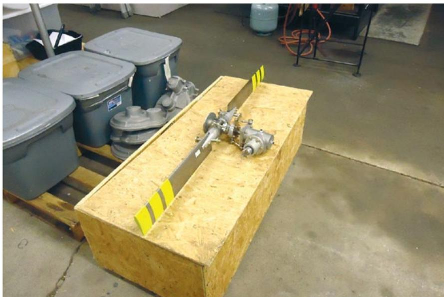
Рулевой винт и хвостовой редуктор в сборе
