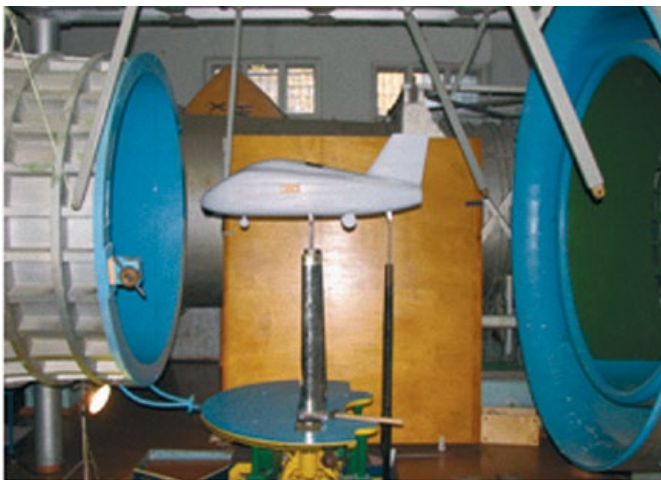
Продувки в аэродинамической трубе Т-6 ХАИ позволили точнее определить аэродинамические характеристики AVQ
