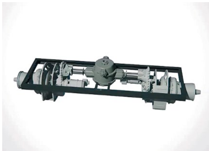
СУ из двух ГТД AI-450M расположена на выдвинутой раме
