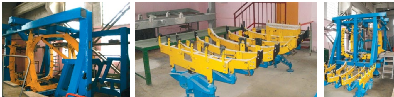
Стапели и эталоны формы для изготовления агрегатов фюзеляжа вертолетов
