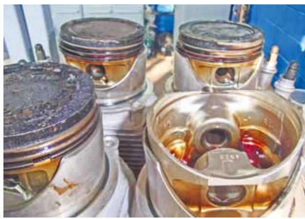
Рабочая поверхность поршней до выполнения работ
