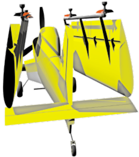
Для удобства транспортировки и хранения крылья «Аграр» легко складываются
