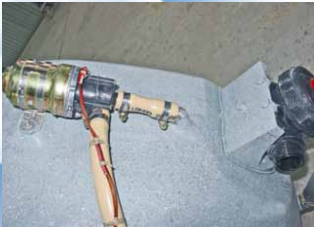
Насос для перемешивания раствора
