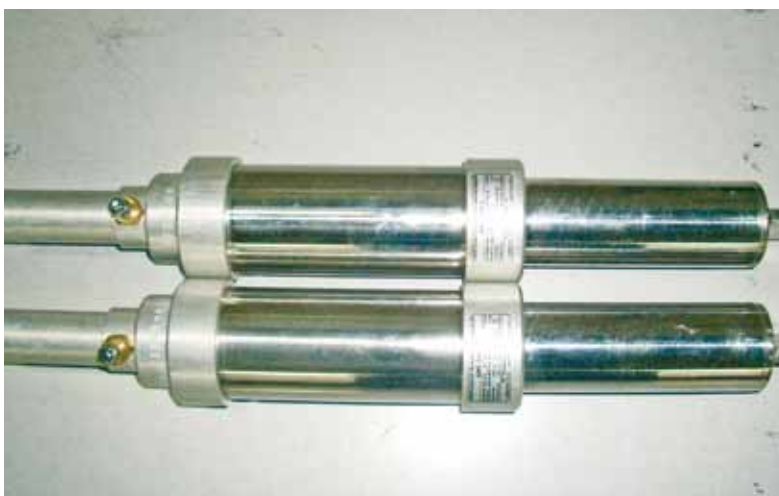
Авиационный жидкостно-газовый амортизатор АЖГ-500.3
