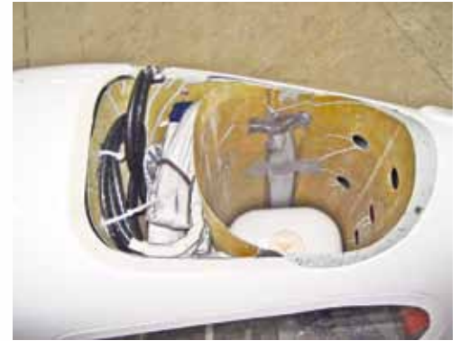
Парашютная система спасения находится позади кабины. За креслом пилота видна дуга безопасности
