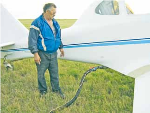
Заправка химикатами осуществляется под давлением снизу бака
