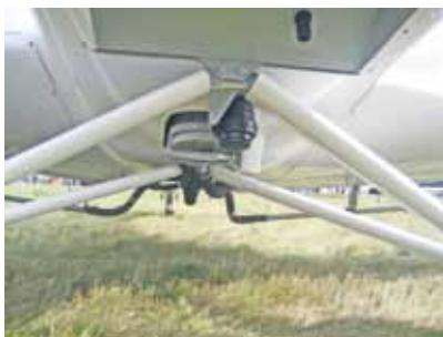
На самолете установлена форсуночная система опрыскивания (Киев)
