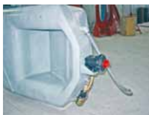
Химбак самолета «Фермер-2» с насосом гидроперемешивания и фильтром грубой очистки
