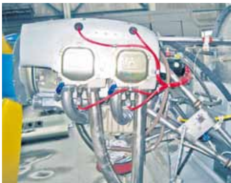
Двигатель Superior IO-360
