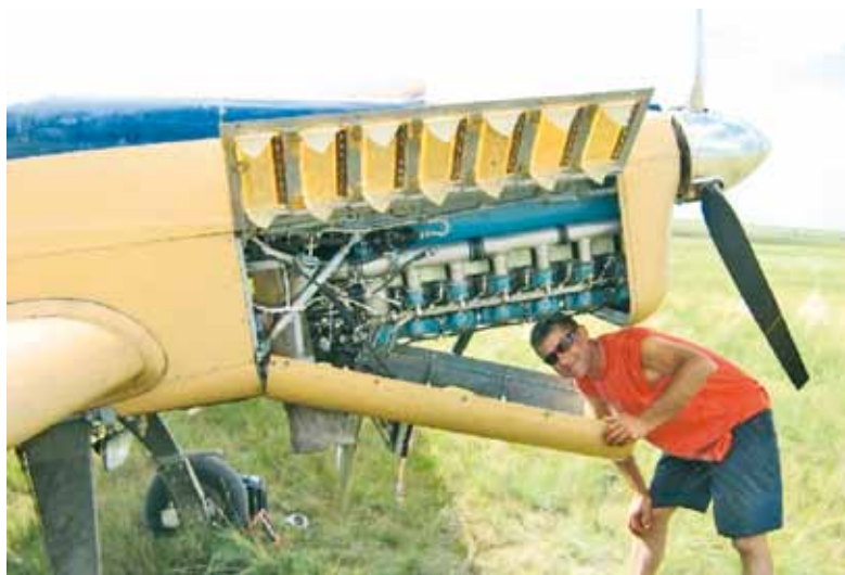
Капот двигателя с дефлекторами системы охлаждения
