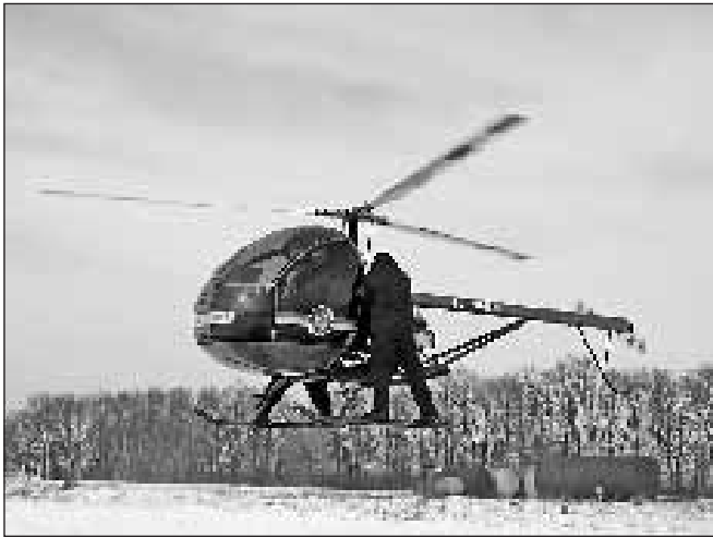
Рис. 4. Висение вертолета с полетной массой 750 кг
