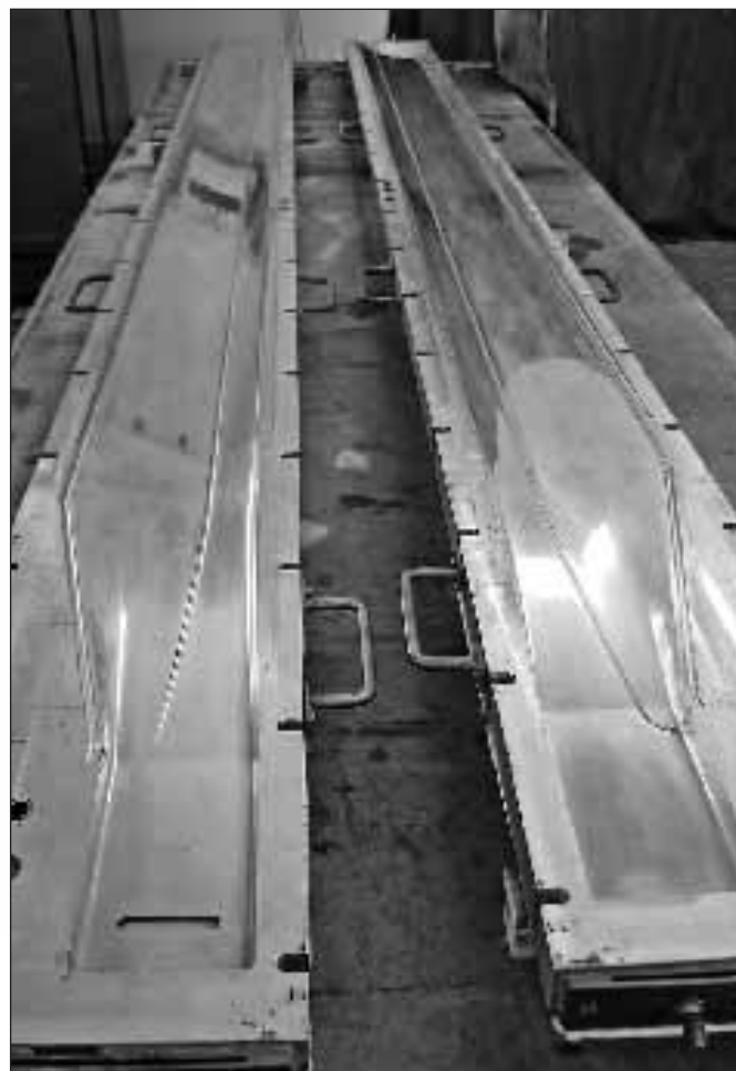
Рис. 7. Пресс-формы для изготовления лопастей вертолета АК1-3
