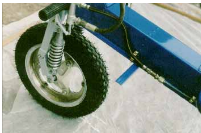
Носовая стойка шасси дельталаета С-7
