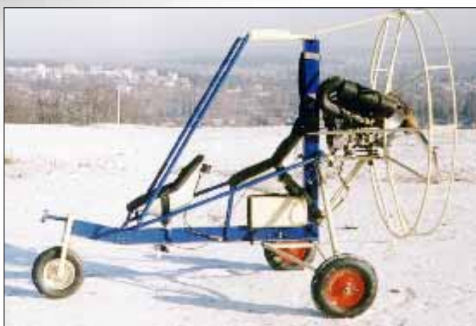
Тележка мотопараплана С-9. Изготовлена на базе дельталета С-7
