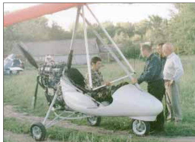
С-7 с двигателем Subaru, крыло А-16
