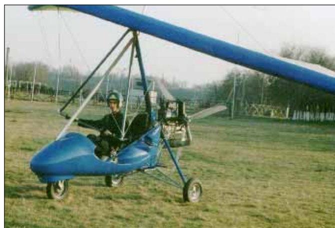
С-7 с двигателем Rotax-582. Крыло Stranger
